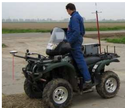
Afb. 2 RTK-set gemonteerd op een quad; gps-antenne/wijzer en BC zijn aan een zijkant gemonteerd (Foto: Loonbedrijf Breure).
